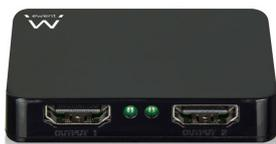
**El Divisor 4K HDMI Ewent EW3720 4K divide una sola señal HDMI en dos televisores/pantallas independientes. Conecte el EW3720 con un cable HDMI de alta velocidad con una resolución máxima de 4K de 3840x2160 a 30 Hz y una resolución (3D) de 1080p a 60Hz. El EW3720 se proporciona con un cable de alimentación USB.**
