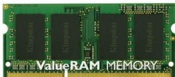
*Capacidad: 8 GB Tipo de memoria interna DDR3 Velocidad de memoria del reloj\* 1600 MHz Forma de factor de memoria\* 204-pin SO-DIMM Latencia CAS\* 11 Ancho de datos 64 Bit Configuración de módulos 1024M x 64 Tipo de memoria PC-12800 Tipo de embalaje SO-DIMM Memoria sin buffer Voltaje de memoria \* 1.5 V Indicación de error No-ECC Número de pines 204*
