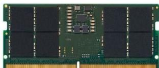
**Especificaciones** Latencia CAS: 46 Memoria interna: 16 GB Diseño de memoria (módulos x tamaño): 1 x 16 GB Tipo de memoria interna: DDR5 Velocidad de memoria del reloj: 5600 MHz Forma de factor de memoria: 262-pin SO-DIMM Voltaje de memoria: 1.1 V
