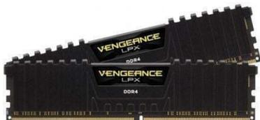
La memoria VENGEANCE LPX se ha diseñado para overclocking de alto rendimiento. El disipador de calor, fabricado en aluminio puro, permite una disipación térmica más rápida, la placa impresa de ocho capas administra el calor y proporciona una capacidad superior para incrementar el overclocking.
